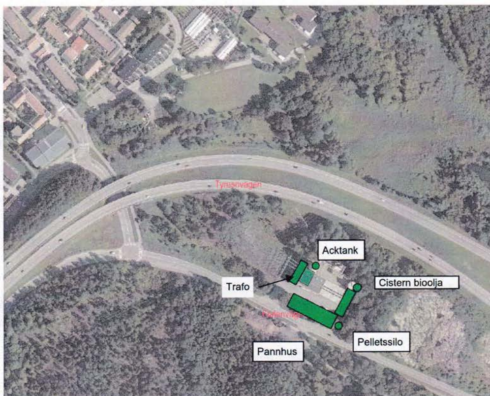
Figur 2. Planerad verksamhet (gröna rutor) och en möjlig placering. I pannhuset finns två nya förbränningspannorna (en för bioolja och en för träpellets). Biooljan förvaras i en cistern och träpellets i en silo. Trafo (transformatorstation) förser anläggningen med ström och acktank (ackumulatortank) är fylld med varmt vatten och fungerar som ett värmelager till fjärrvärmenätet.
